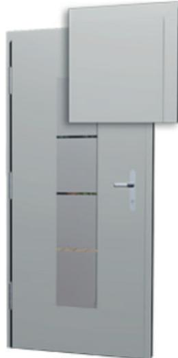
Beidseitig flügelüberdeckende Füllung, 92 mm Gesamtstärke UD-Wert = 0,67 W/m<sup>2</sup>K (Berechnungsbasis DIN EN ISO 10077-1, Tür 1200 x 2250 mm mit komplett geschlossener Türfüllung, ohne Glas)
